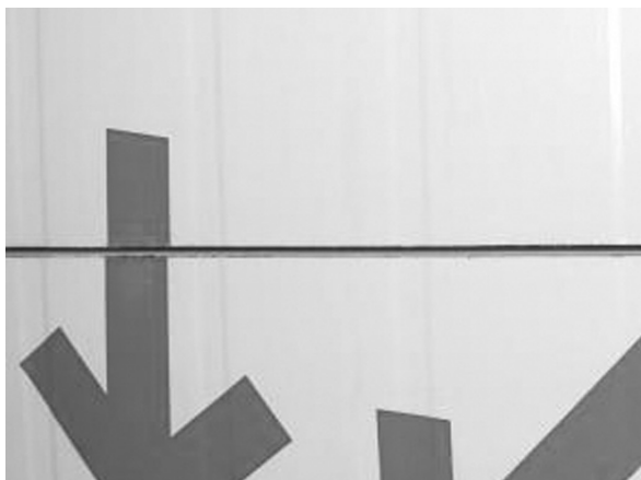
Рисунок 20: Резка панелей циркулярной пилой со специальным диском для сандвич-панелей (справа показана «идеальная» линия реза).
