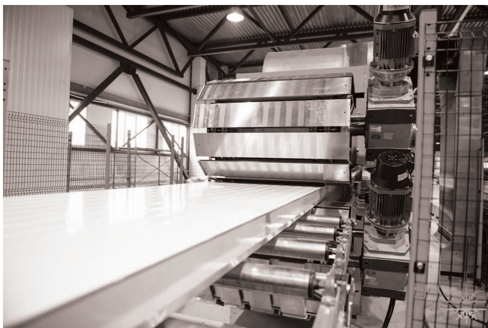
Рисунок 4: Участок непрерывной линии производства сэндвич-панелей ПрофХолод (РиМа, Италия).
