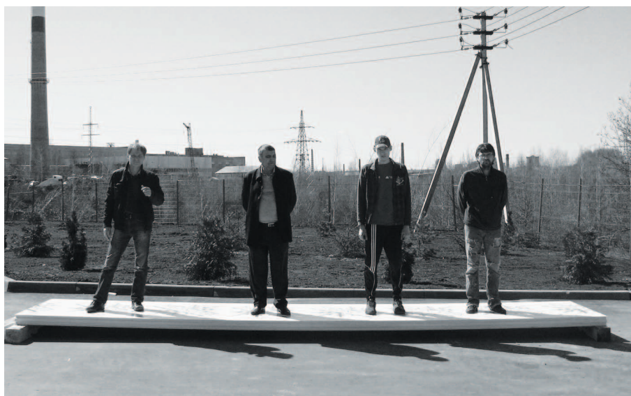
Рисунок 16: Наглядная демонстрация “несущих” свойств сэндвич-панелей со средним слоем из ППУ (суммарная нагрузка 320 кг, толщина 100мм, длина панели 6м).
