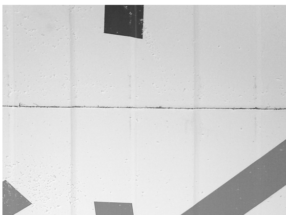
Рисунок 19: Резка панели электрическим лобзиком и получаемая при этом линия реза.
