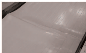
Рисунок 17: Образование складки на поверхности сэндвич-панели при сжатии верхнего слоя.
