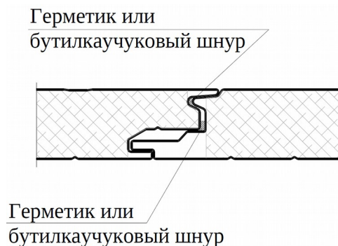
Рисунок 6: Стык стеновых панелей с замковым соединением со скрытым креплением SECRET FIX (ПСТ SF)
